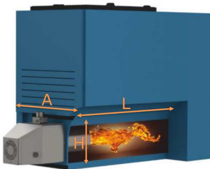
Rys. 3. Umiejscowienie palnika z uwzględnieniem kierunku płomienia.
