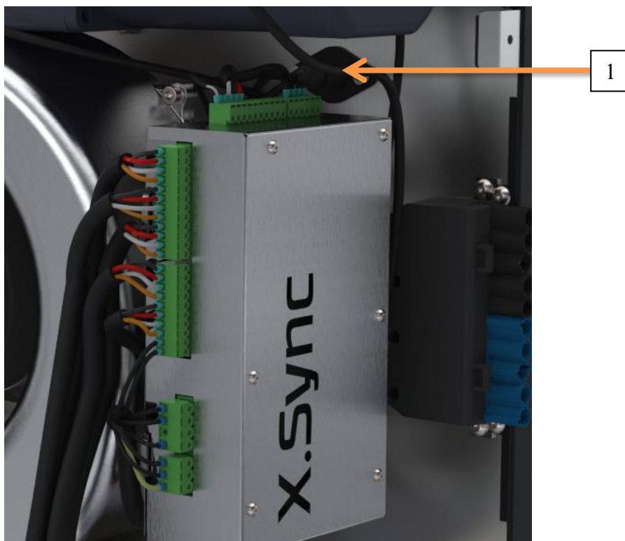
Rys. 15. Pozycja fotosensora (1) w palniku M350 i M500.
