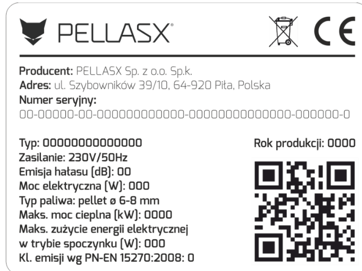
Rys. 3. Wzór tabliczki znamionowej palnika.
