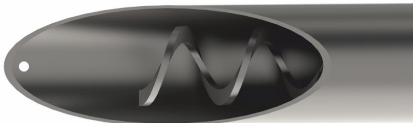
Rys. 5. Montaż spirali podajnika.
